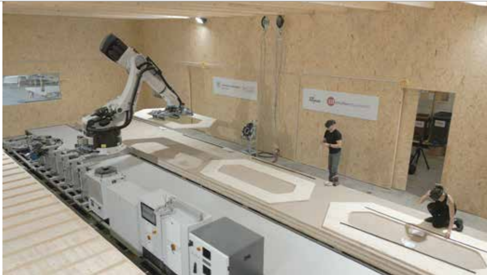
Vorfertigung der Hohlkassetten über eine zwölf Meter lange Roboterplattform.
